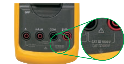
Bruk metre med følgende merking: 1000 V CAT III eller 600 V CAT IV
